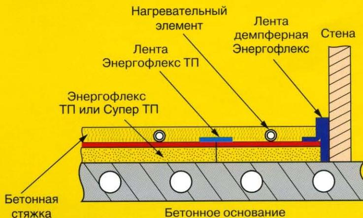
Материалы «Энергофлекс ТП» и «Энергофлекс Супер ТП» в сочетании с аксессуарами для монтажа являются готовыми к применению теплоизоляционными системами, позволяющими значительно сократить время монтажа и увеличить энергоэффективность работы «теплых полов».
